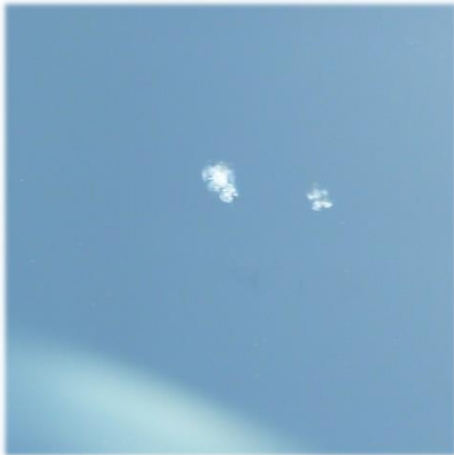
Glasschaden mit Rissbildung, eine Reparatur ist unter Einhaltung der Vorschriften möglich.
