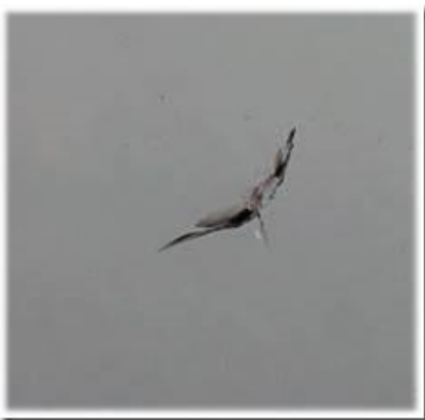
Glasschaden mit Rissbildung, eine Reparatur ist unter Einhaltung der Vorschriften möglich.
