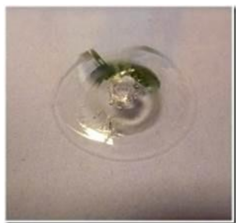
Glasschaden mit Rissbildung, eine Reparatur ist unter Einhaltung der Vorschriften möglich.
