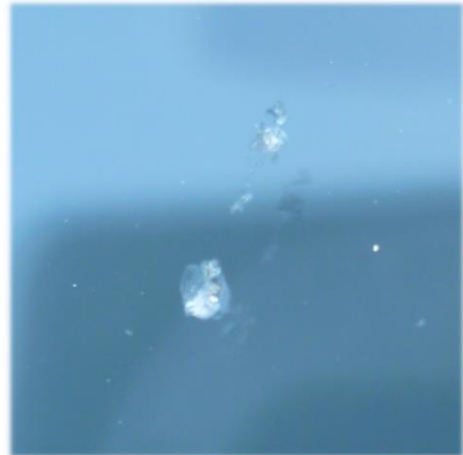
Glasschaden mit Rissbildung, eine Reparatur ist unter Einhaltung der Vorschriften möglich.
